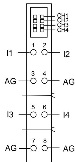
模拟量输入 ( 电流信号 ) 接线
