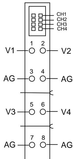
**模拟量 (电压信号) 输入接线:**
